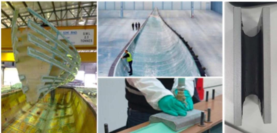
Heutige Schiffskonstruktionen basieren häufig auf geschweißten Grobblechen. Neue Entwicklungen in der Klebtechnik ermöglichen das Fügen großflächiger Strukturen aus Metallen und Faser-Kunststoff-Verbunden. Daraus ergeben sich neue Möglichkeiten für Konstruktionen, die in ihrer Gestaltungsfreiheit und Funktionalität gesteigert und gleichzeitig in ihrer Masse reduziert werden.
